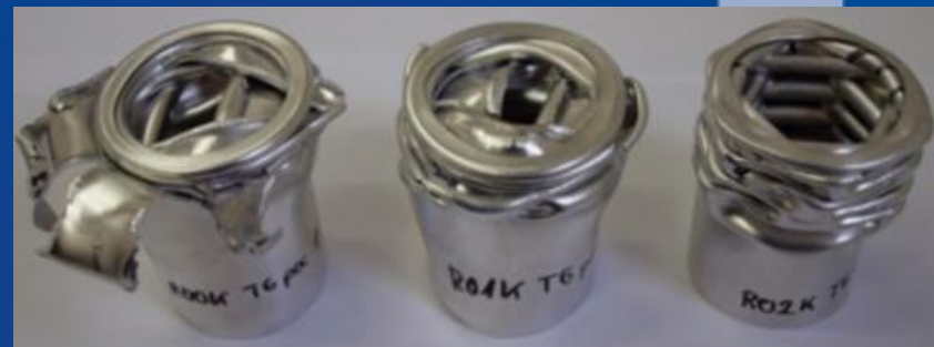
Kształtowniki ze stopu aluminium serii 6xxx z dodatkiem wanadu po równoosiowym odkształceniu symulującym „crush test”
