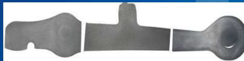
Makrostruktura odkuwki wahacza wykonana z materiału odlewane go ze stopu Al
