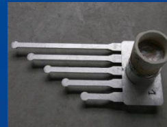
Skłonność do pęknięć
