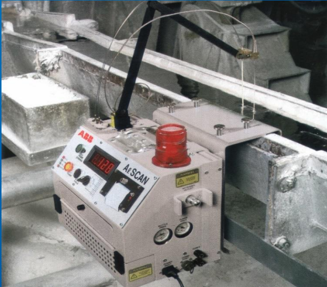
Pomiar zawartości wodoru on line Aparat Alscan
