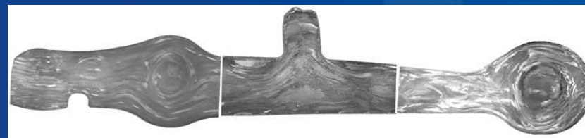
Makrostruktura odkuwki wahacza wykonana z pręta wyciskanego ze stopu Al
