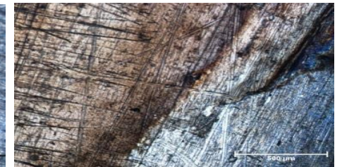
Osad anodowy ( \text{NiO}_2 ) Osad katodowy (Cu)
