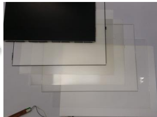
Demontaż warstwy ITO Tlenek indowo cynowy
